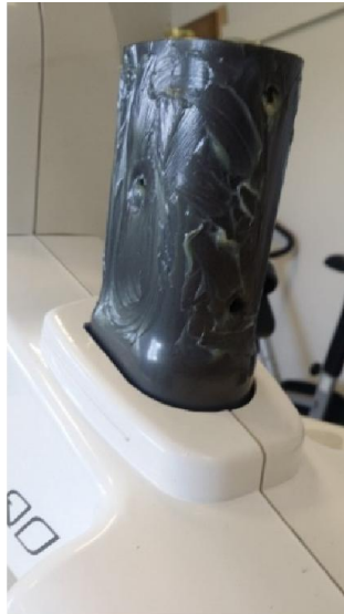
Mazacím tukem namažte celý povrch – viz. obrázek
